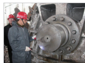
SHAFT-UT 검사 Shaft-ut testing
